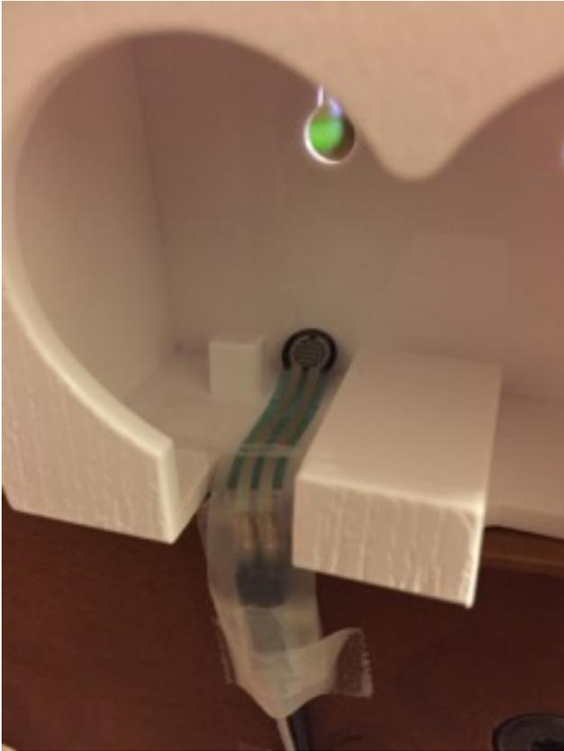
キーホルダーの鳥の尾が触れる位置に感圧センサーを取り付けます。動作を確認しながら調整してください。
